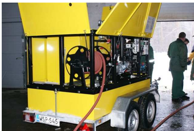
Attēlā: Tvaika ģenerators aizsalumu tīklos atkausēšanai, aerotenku apkopei
